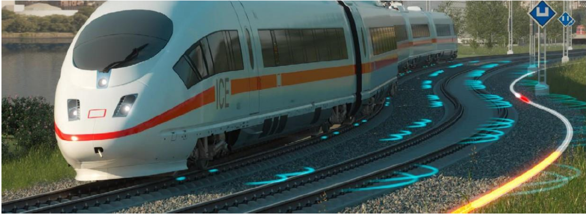
Rys. 4. Drgania powodowane przejazdem pociągu są poprzez warstwy ziemi przekazywane do światłowodu
